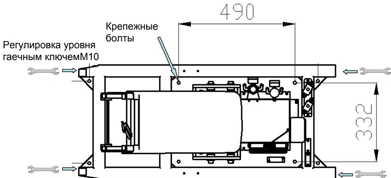
В. Отрегулируйте 4 болта по уровню внутри каркаса установки, чтобы стабилизировать ее.
