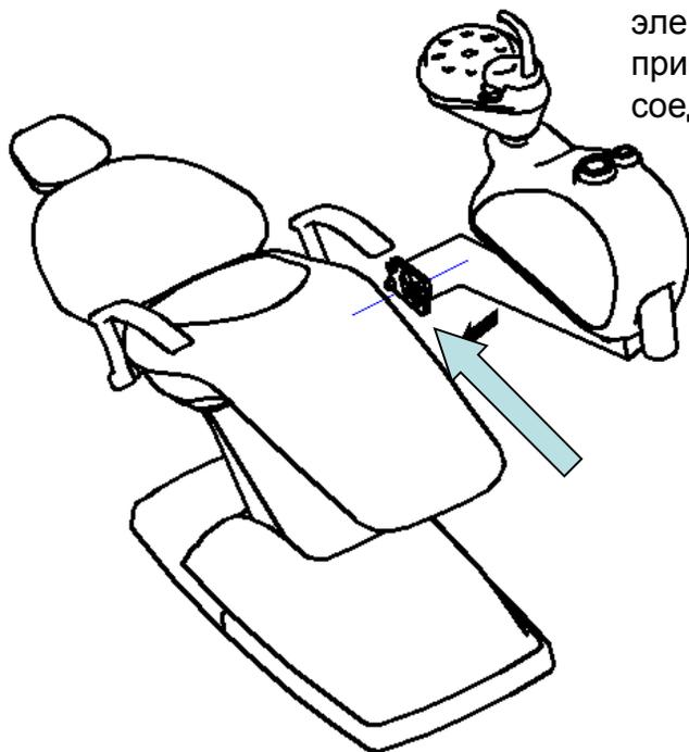
После соединения разъемов к электричеству, воздуху и воде прикрепить гидроблок к креслу 4-мя соединительными болтами
