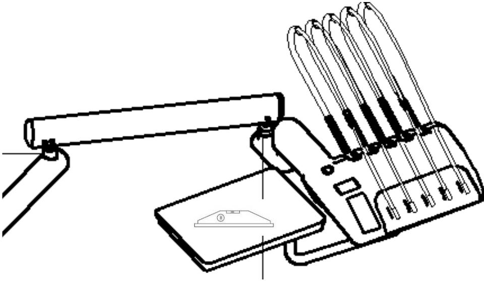
Ф. Подсоедините электрокабель, водную, воздушную и дренажную трубки к соответствующим разъемам.
