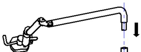
Вставить штангу лампы в отверстие в гидроблоке.
